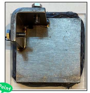
床へ設置後、接着剤が治具からはみ出している
